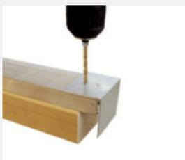
Die Alu-Haltewinkel werden an den unteren Stirnseiten der Mittel- und Randprofile mit je 2 Schrauben 4,8 x 16 mm befestigt
