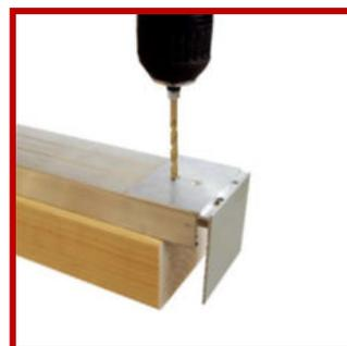
**Tipp:** Oder verwenden Sie zur Befestigung des Abschluss- und Haltewinkels unsere Scobalit Bohrschrauben (5,5 x 34 mm). So entfällt das vorbohren. Eine Schraube pro Winkel ist ausreichend.
