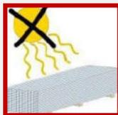
Nicht in der prallen Sonne lagern. Bei Lagerung im Stapel besteht die Gefahr der Verformung bei direkter Sonneneinstrahlung. Lagern Sie die Platten plan und schützen Sie vor Verschmutzung und mechanischer Belastung. Als Abdeckung eignet sich beispielsweise eine weiße Folie oder ein starker Karton.
